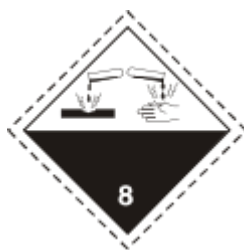
Fig.14. klasa 8. Materiet korrozive
